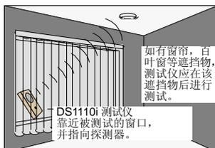
应使用DS1101i玻璃破碎测试仪进行该项测试。DS1101i产生使探测器报警的高频音，以进一步校验适当的安装位置。
