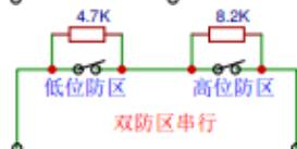
➤ **双防区串行防拆：**使用 2.2k/4.7k/8.2k 组合，只能接常闭探测器。4.7K 电阻与探测器的防区端子并行连接作为低位防区；8.2K 电阻与探测器的防区端子并行连接作为高位防区；2.2k 电阻与探测器的防拆端子串行连接作为防区防拆。防区回路与防拆回路串行连接。必须启用“防拆”选项，防区防拆才有效，防拆防区为低位防区
