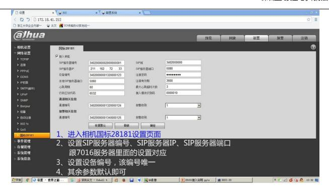
2、 所有厂家的 28181 设置都是类似的,如果相机无法上线;尝试修改平台的 SIP 服务器端口仍然无法上线的话,只能通过抓取网络包分析处理;如果设备上线无法出图,检查 7016 的 40000-60000 端口是否开放,如果不行,只能抓包分析。
