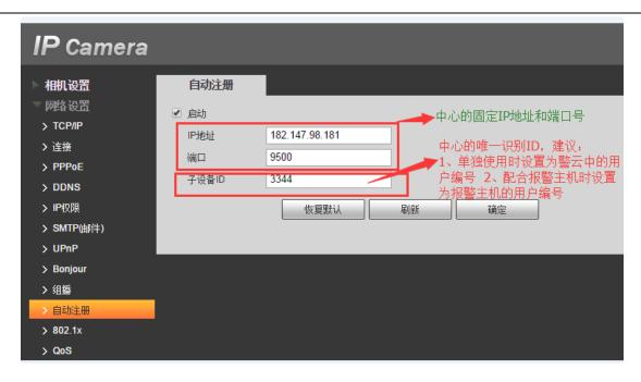
5、 **丛文警云:**在网络设置—丛文警云中,依次输入中心 IP 地址,警云端口号。如果需要启用视频设备的报警功能,还需要设置用户编号,启用相应的防区。
