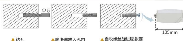
▲ 钻孔 ▲ 膨胀塞放入孔内 ▲ 自攻螺丝旋进膨胀塞
